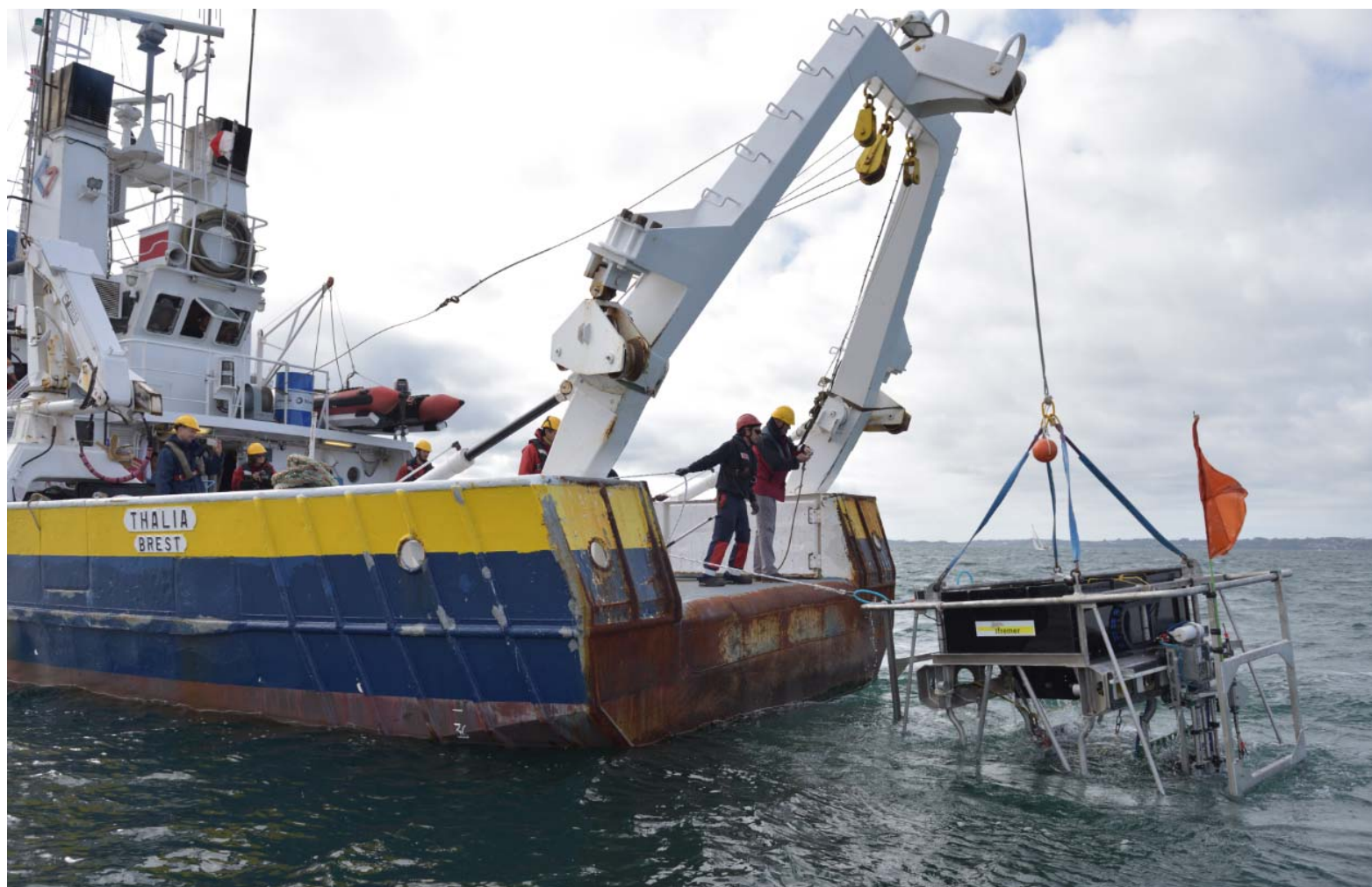
Mise à l'eau d'une station de fond sur NO Thalia
