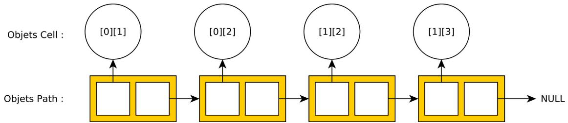
Figure 2: Le `Path` (chemin solution du labyrinthe) est une *liste chaînée* d'éléments pointant vers des objets `Cell`. Chaque élément chaîné (en jaune) contient donc un pointeur vers une cellule du labyrinthe, et un pointeur vers l'élément `Path` suivant. Un objet `Path` représente donc à la fois une liste chaînée, ainsi que le premier élément de cette liste. Le dernier élément n'existe pas : il est `NULL`.
