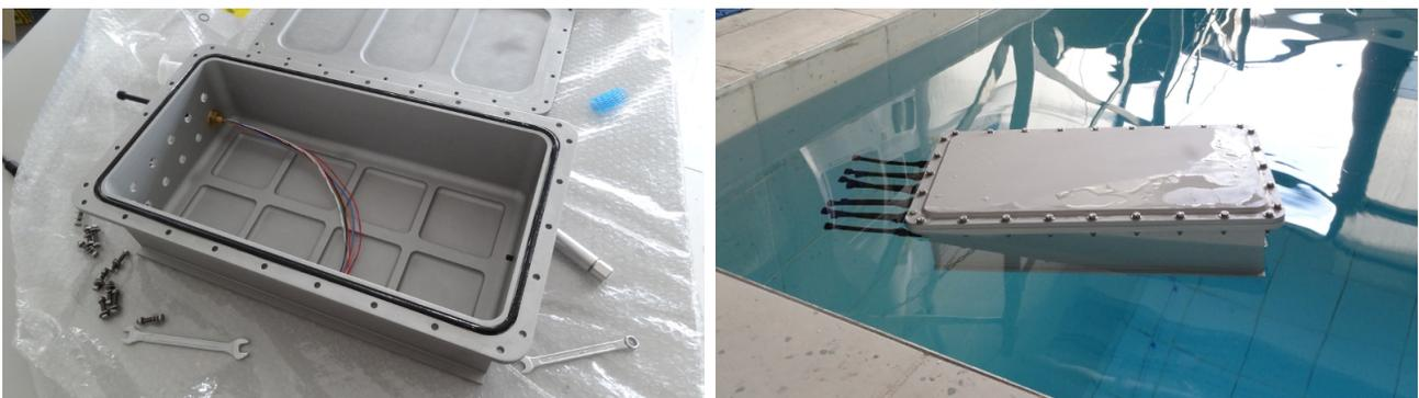
FIGURE 8 – La boîte lors de sa réception - tests d'étanchéité et de flottabilité
