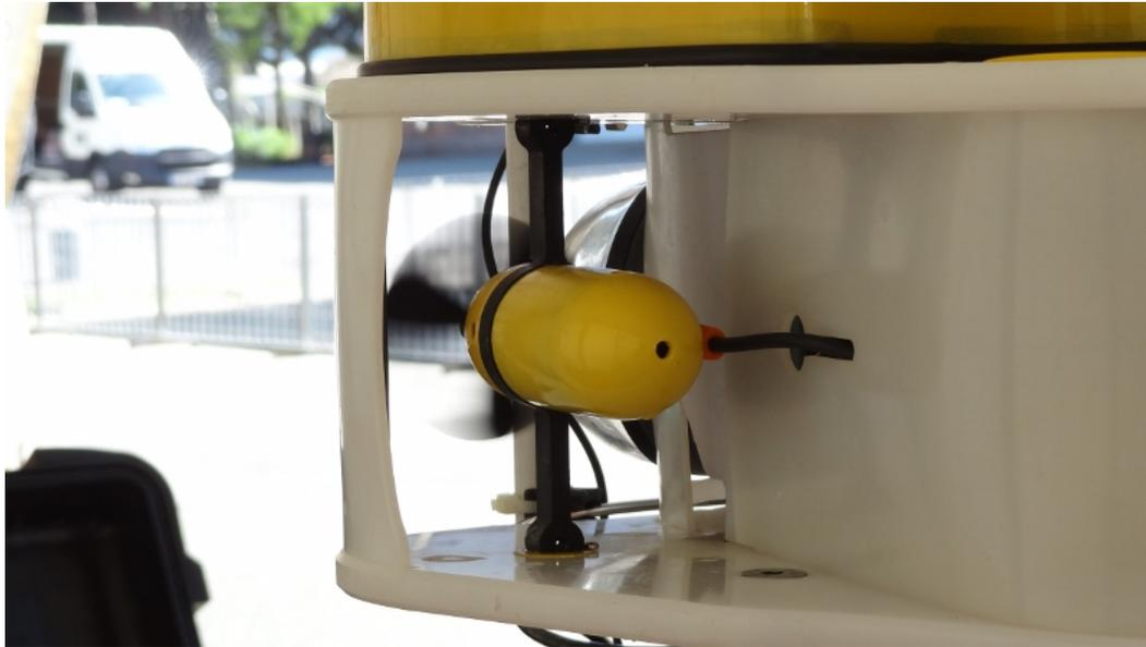
FIGURE 5 – L'un des 6 propulseurs du CISCREA, en action
