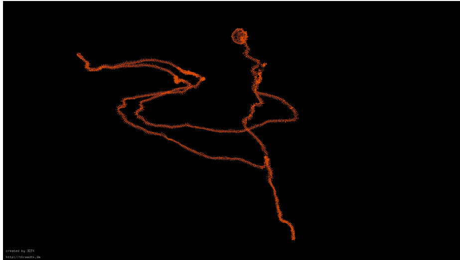
fig II.2 : Vue du dessus de la trajectoire du robot sans SLAM. On voit particulièrement bien le drift sur la branche du karst à gauche de l'image.
